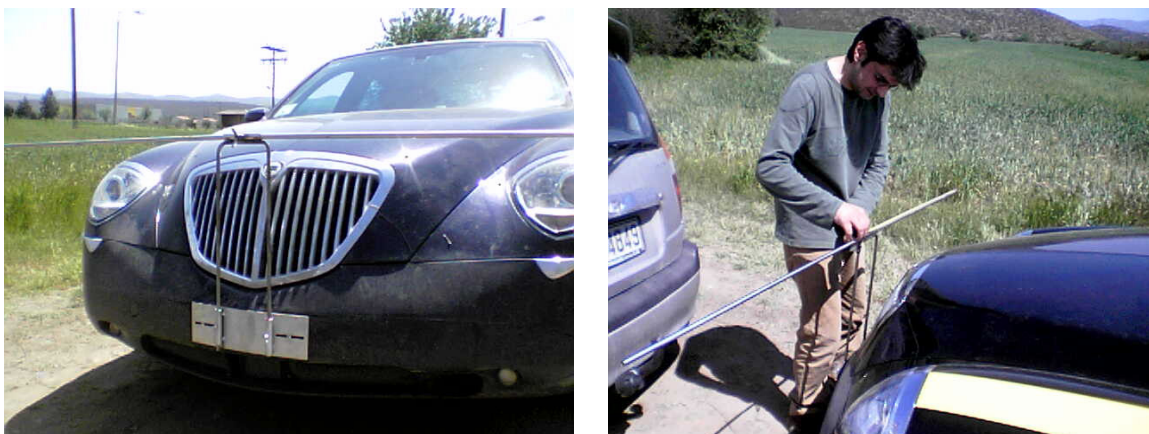
Εικόνα 4: Συσκευή υποβοήθησης εκτίμησης των εμπρόσθιων ορίων του ερευνητικού οχήματος.
