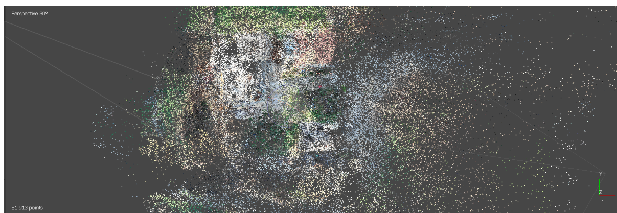
Εικόνα 13: Η μορφή του point cloud έχει φανερά τα χρώματα των φωτογραφιών και τα εικονιζόμενα αντικείμενα ξεκινούν να παίρνουν αμυδρά μορφή στο panel
