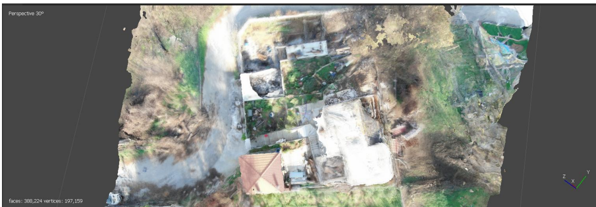
Εικόνα 23: Σε αυτό το σημείο οι εικόνες διαθέτουν το φίλτρο του structure οπότε η δόμηση και η γέμιση των τυφλών σημείων αποτυπώνεται με σημεία του ίδιου είδους όπως και τα γειτονικά.
