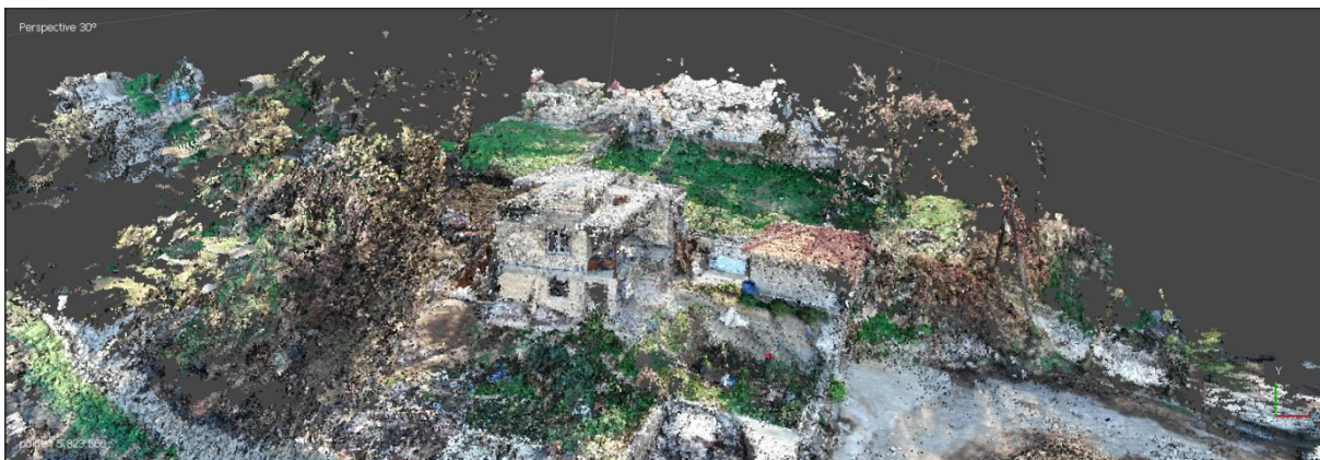
Εικόνα 16: Η επιλογή του τελικού μοντέλου δίνει την αίσθηση ένωσης του νέφους σημείων και παρουσιάζει το οικόπεδο σε τρισδιάστατο σχεδιασμό. Είναι φανερό πως του λείπει η επιλογή της τελικής επιλογής της δόμησης των σημείων.
