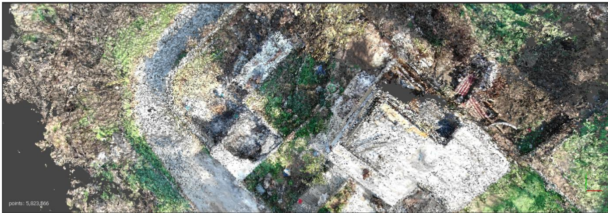
Εικόνα 22: Από την πλευρά της ορθογώνιας προβολής του τρισδιάστατου μοντέλου παρουσιάζεται η βέλτιστη λεπτομέρεια καθώς οι περισσότερες και πιο ορθές λήψεις έγιναν κάθετα με την πτήση του drone.
