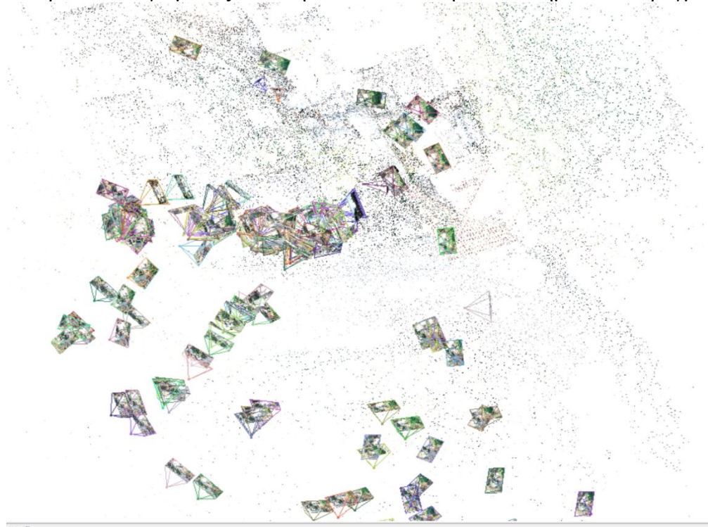
Εικόνα 8: η εικόνα του Visual SfM περιέχει στοιχεία από την γεωγραφική τοποθεσία των φωτογραφιών και τις έχει παρουσιάσει μέσα στο point cloud το οποίο παίρνει μορφή.
