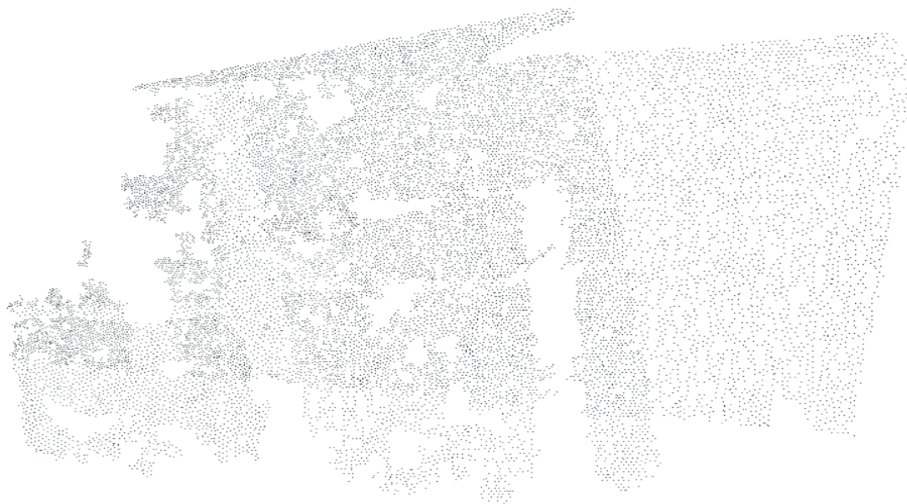
Εικόνα 7: Point cloud CMVS-PMVS είναι ακόμα ένα πολύ αρχικό στάδιο δημιουργίας ενός point cloud παρόλα αυτά όμως είναι φανερό το σχήμα του οικόπεδου όταν το κοιτάμε από πάνω.
