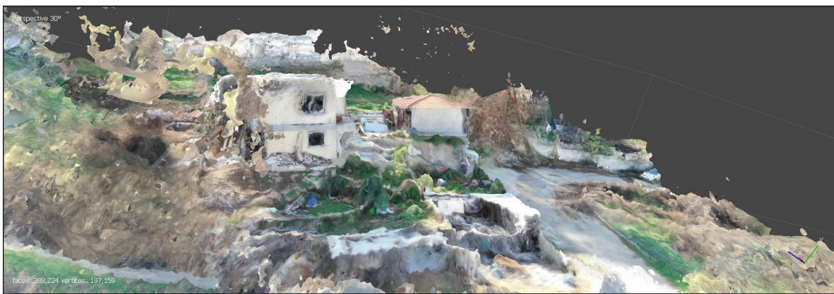
Εικόνα 27: Σε αυτή την εικόνα με την πάγια προβολή από την ανατολική πλευρα του σπιτιού υπάρχουν σοβαρές ασυνέχειες στην δόμηση των στοιχείων και με αυτό το τρόπο υπάρχει η αίσθηση ρενστότητας των επιφανειών που δεν οφείλεται μόνο στην καταστροφική πυρκαγιά.
