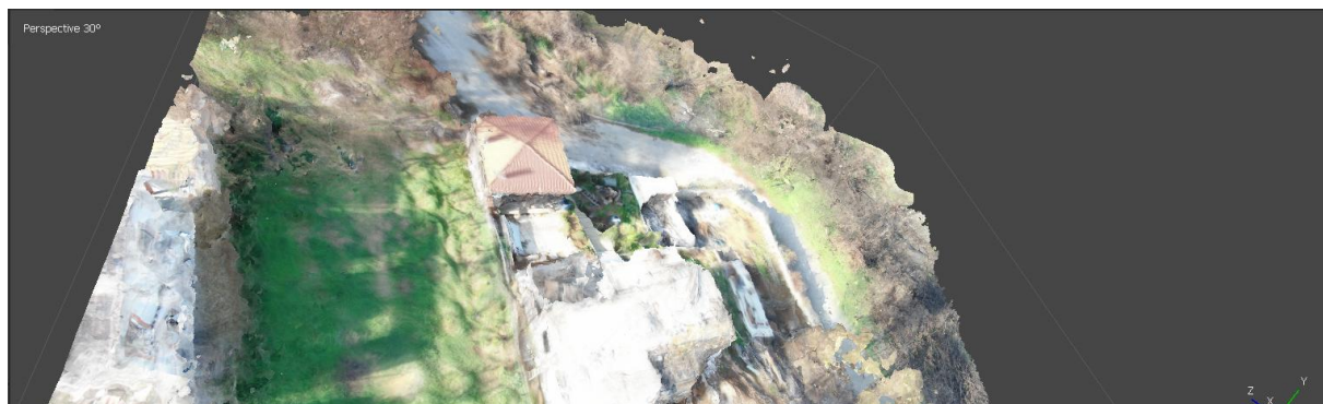
Εικόνα 24: Η εντολή structure δίνει το τελικό αποτέλεσμα και με βάση την πληροφορία των φωτογραφιών μπορούν να επιλεγθούν τα βέλτιστα σημεία οπτικοποίησης.
