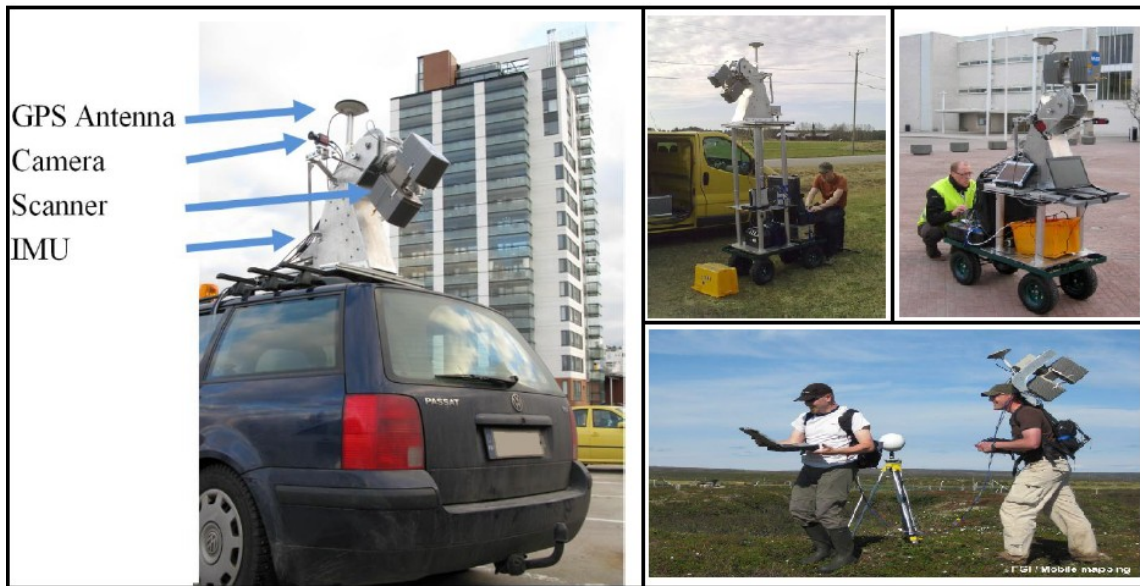
Εικόνα 9: Επίγειες κινητές μονάδες σάρωσης
