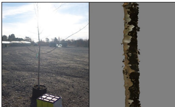
Εικόνα 25: Δυσκολία αποτύπωσης τμήματος επιφάνειας λόγω σκιών που δημιουργήθηκαν από το φως του ήλιου
