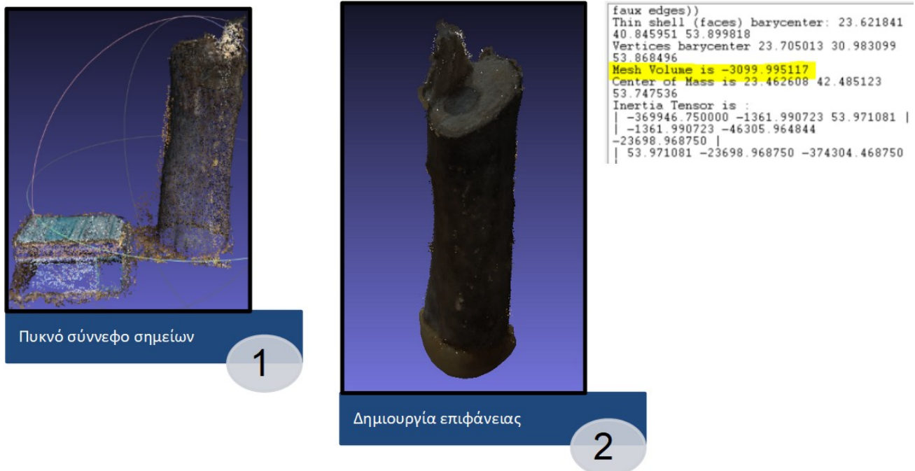
Εικόνα 23: Δημιουργία επιφάνειας και υπολογισμός όγκου του ξύλου
