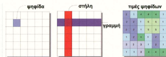
Σχήμα 4-8. Στοιχειώδης δομική επιφάνεια (cell) και γεωμετρική σύνθεση του ψηφιδωτού μοντέλου (πηγή: ESRI, 2001)
